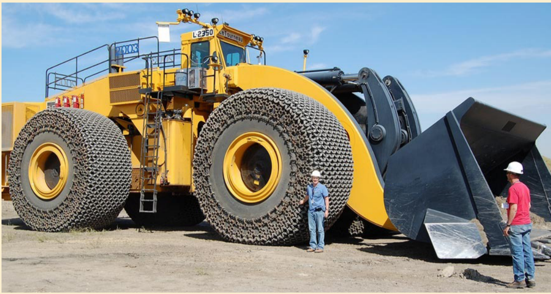
P&H L-2350 er með 2.300 hestafna mótör og hefur verið framleidd af Komatsu frá 2016 eftir 3,7 milljarða dollara yfirtöku á námuvélaframleiðandanum Joy Global.
