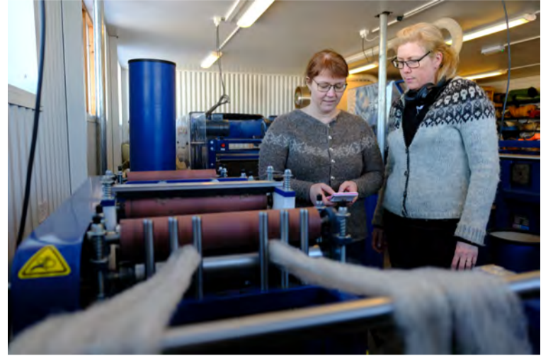
Hulda með samstarfskonu sinni, Björgu Kristínu Björgvinsdóttur, við eina af vélum Uppspuna, dráttarvél sem jafnar lyppurnar fyrir spunann.
