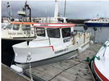
Strandveiðibátur / Sjóstöng / Skemmtibátur. Sverrir GK31. Skipaskrárnúmer 6507. Brúttó rúmmál: 3,4. Brúttótonn: 3,01. Lengd: 6,95 m. Vél: Yanmar 2011. Keyrður 1.500 tíma. Hældrif: Yanmar 370 árg. 2016. Keyrt 400 tíma. Tæki í brú: AIS, GPS Plotter, sjálfstýring, 2 talstöðvar, dýptarmælir, útvarp, inverter 24v/220v/1000W. Baturinn gengur um 15 mílur og með 800 kg gengur hann um 9,5 mílur og hann eyðir um 23 lítrum á kist, það eru 6 kór í lest og eitt ískar aftan á það fer um 220 kg í kar. Góður bátur í strandveiðina. Verð 4,9 milljónir kr. / áhvílandi 0 kr. Ath. skipti á sumarbústaðarlöð eða löð fyrir atvinnuhúsnæði innan við 300 km frá Reykjavík. Uppl. í síma 780-4141, Grétar.
