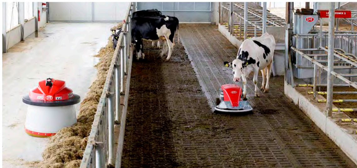
Tvö af mjög vinsælum sjálfvirkum hjálpartækjum í íslenskum fjösunum. Til vinstri er Juno fódursópur sem sér um að yta fódurinu að kúnum allan sólarhringinn og hægra megin er Lely Center flórskafa. Mynd / Lely
