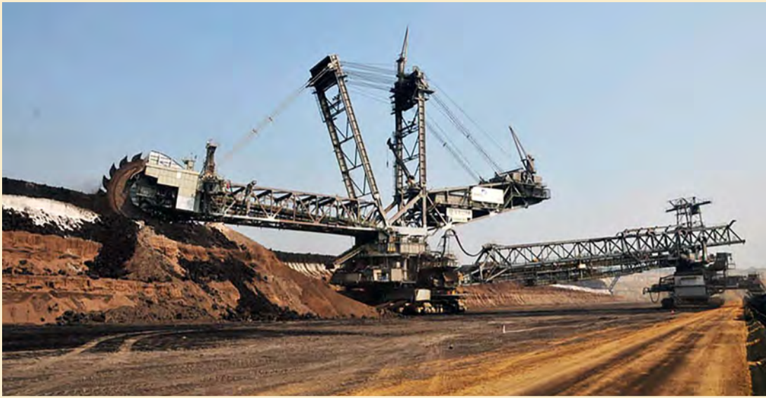
Bagger 288 er stærsta landfarartæki sem smíðað hefur verið. Hún gengur fyrir rafmagni og fær orku í gegnum þokkalega öfluga framlengingarsnúru, því spottinn er 30 þúsund volt.
