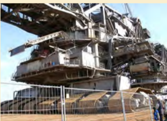
Undir meginvélinni eru tólf Caterpillar-belti sem hvert um sig er 3,8 metrar að breidd.
