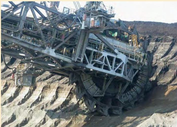
Bagger 288 er með gröfuhjól sem er 21,6 metrar í þvermál og er með samtals 18 skóflum sem hver um sig tekur 6,6 rúmmetra af efni.
