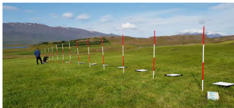
Uppsetning á bakkaprófi og niðurstöðum úr því sett upp á stikur.
