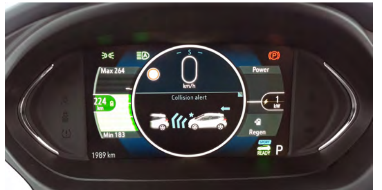
Árekstrarvörnina er hægt að stilla, t.v. er drægnin í km og ef miðstöðin væri sett í gang mundi km-talan lækka mest.
