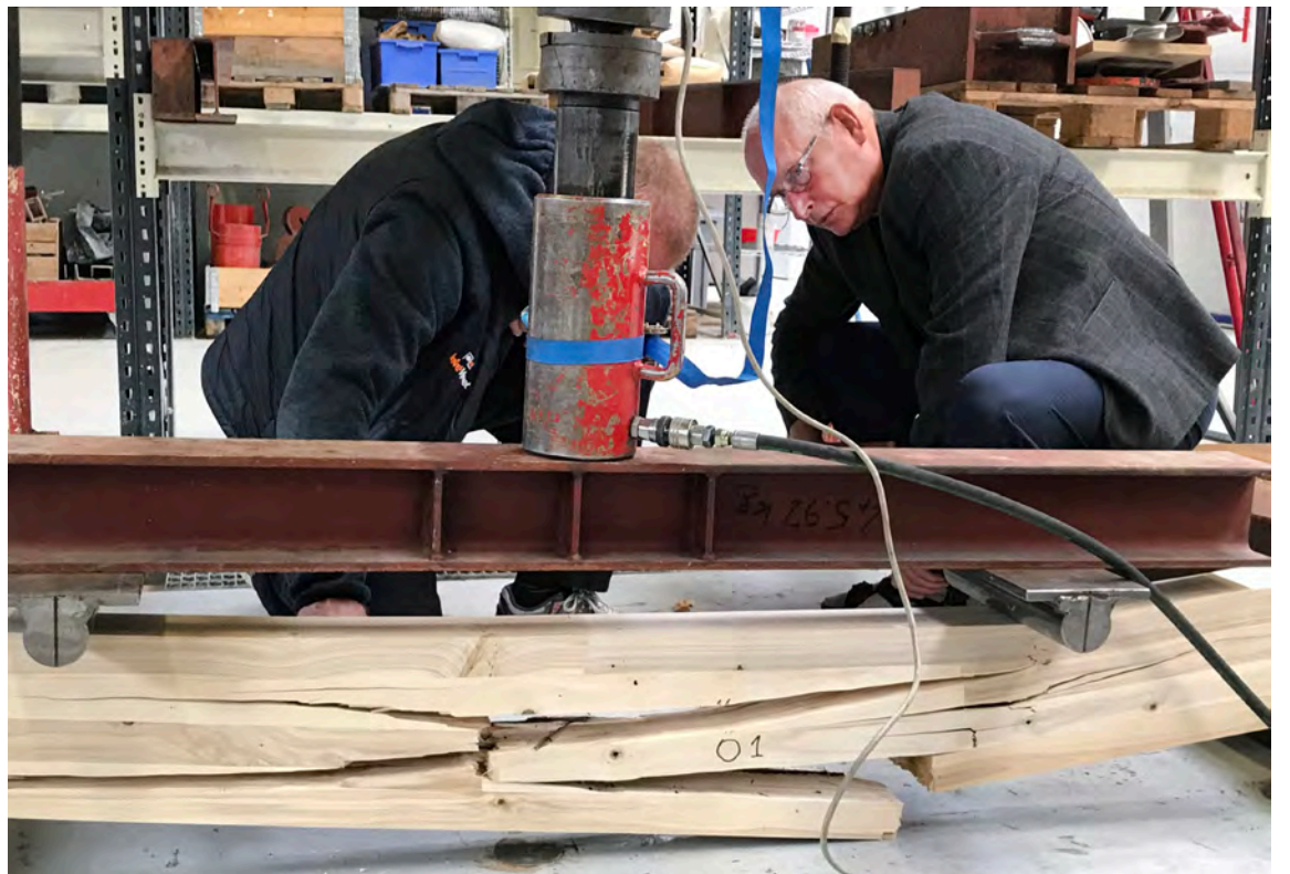
Eiríkur Þorsteinsson, trétæknir og verkefnisstjóri verkefnisins, skoðar ösp undir álagstjaki.
