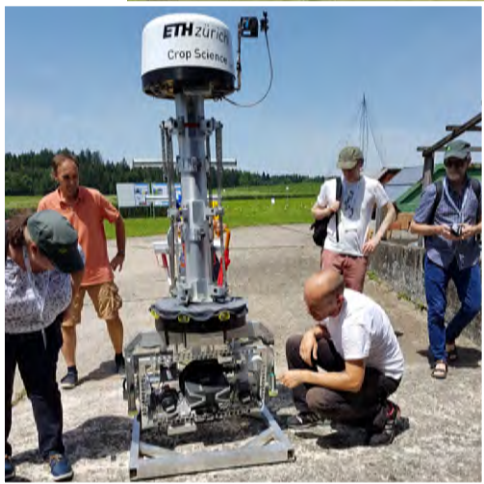
Tæki sem framkvæmir alls konar mælingar á gróðri, það er hengt á vírinn milli mastranna á myndinni fyrir ofan.
