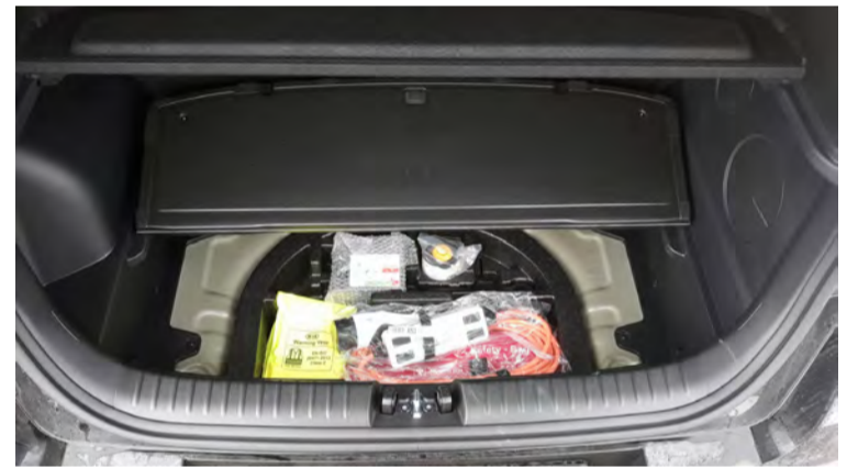
Ekkert varadekk en rafmagnspumpa og vökví í staðinn.
