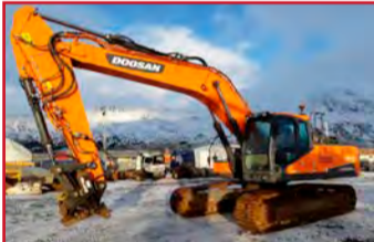
Doosan DX300LC-5 Árgerð: 2016 - Notkun: 7.050 vst. Rótortilt sem hægt er að taka rótorin af. GPS frá Trimble, GB300 fleygur, 4 skóflur og smurkerfi
