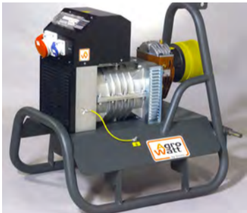
Traktorsdrifnar rafstöðvar (Agro-Watt), www.sogaenergyteam.com - stærðir: 10,8 kW – 72 kW. Stöðvarnar eru með eða án AVR (spennujafnara). AVR tryggir örugga keyrslu á viðkvæmum rafbúnaði t.d. mjólkurþjónum, tölvubúnaði, nýlegum rafsuðum o.fl. Hákonarson ehf. Uppl. í s. 892-4163, hak@hak.is, www.hak.is
