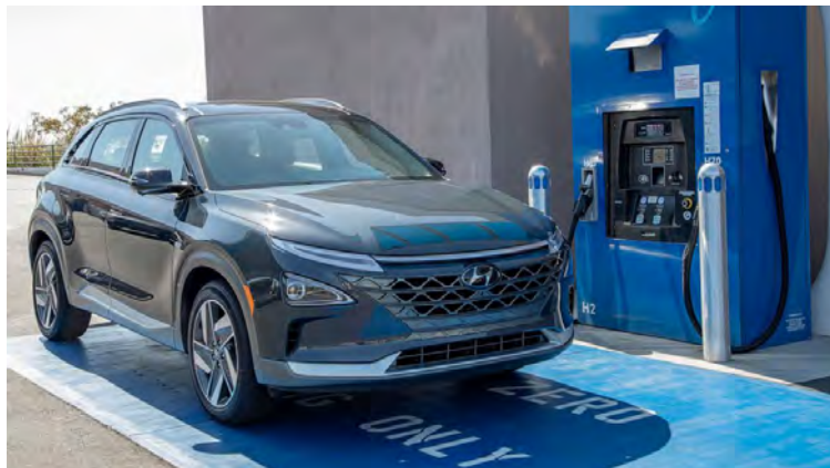
Hyundai með Nexu rafbílinn sem framleiðir rafmagn um borð í gegnum vetnis-efnarafal.
