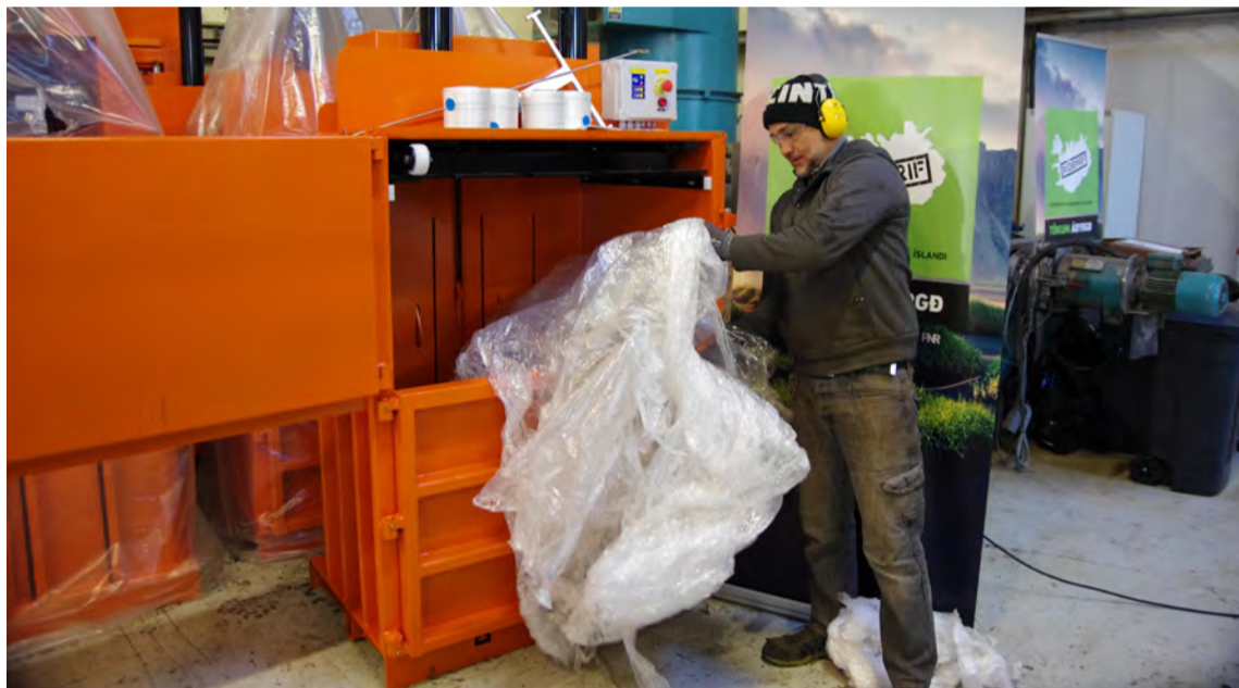
Rafkúin baggapressa sem Pure North Recycling býður bændum og öðrum til kaups til að bagga og minnka umfang á plasti fyrir flutning til endurvinnslu. Mynd / HKR.
