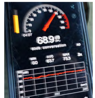
Freka óskýr mynd, en á línuritinu má sjá að mælingin var hærri meðan verið er að ná 90, en lækkaði svo örliðið þegar komið var í jafna keyrslu.
