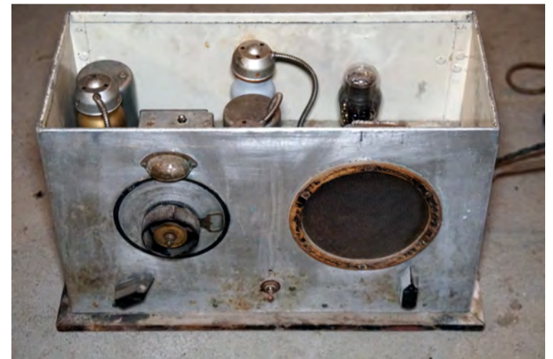
Útvarpstækið VESTRI var líka framleitt fyrir skip og voru smíðuð 200 slíki tæki. Þau tæki voru í málmkassa á meðan hin voru í trékösum.
