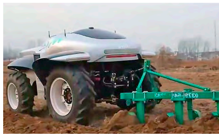
ET504 er vetnisknúin dráttarvél með gervigreind sem les umhverfi sitt og heldur utan um allan stjórnúnað.
