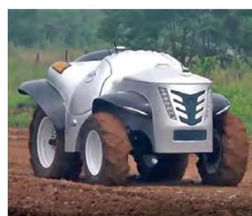
ET504 er vetnisknúin dráttarvél með gervigreind sem les umhverfi sitt og heldur utan um allan stjórnúnað.
