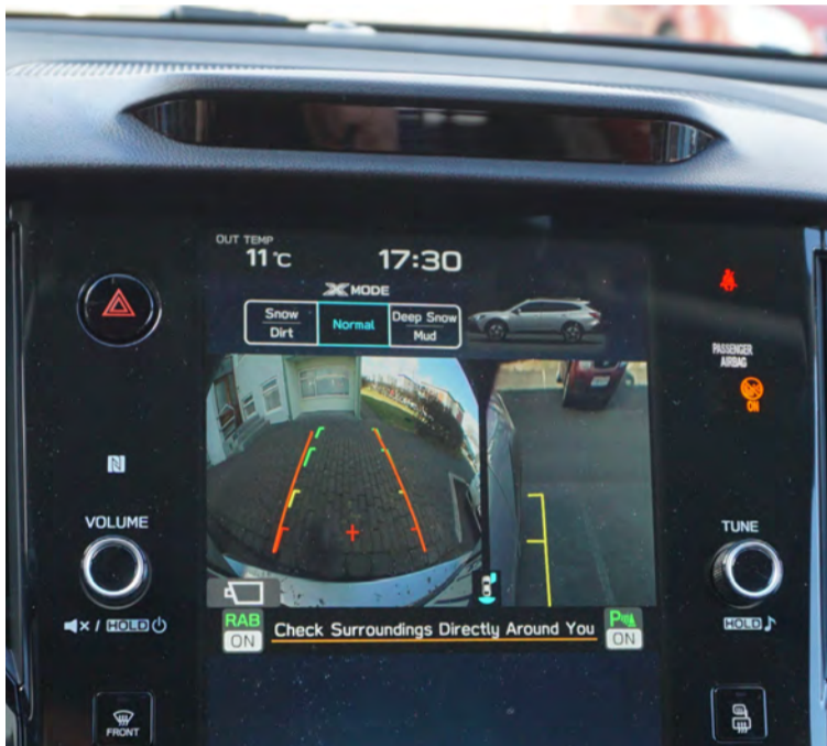
Þegar maður kveikir á takka sem er við girstöngina kviknar á aukamyndavél sem sýnir niður á hægra framhjól.
