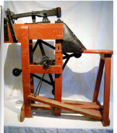
Dengingarvél Guttorms Jónssonar: „Vjelin er all-traust, vel smíðuð, vinnur fljótt og fremur vel, er ljett að stíga og ekki vandnotuð, en er all-stór og þung í vöfum,“ sagði í áliti prófunarnefndar.
