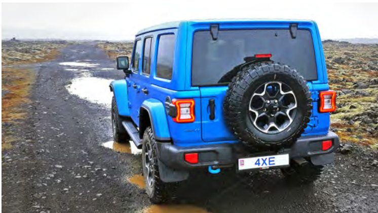
Muna þarf að kveikja ljós í björtu svo að afturljósinn komi á.
