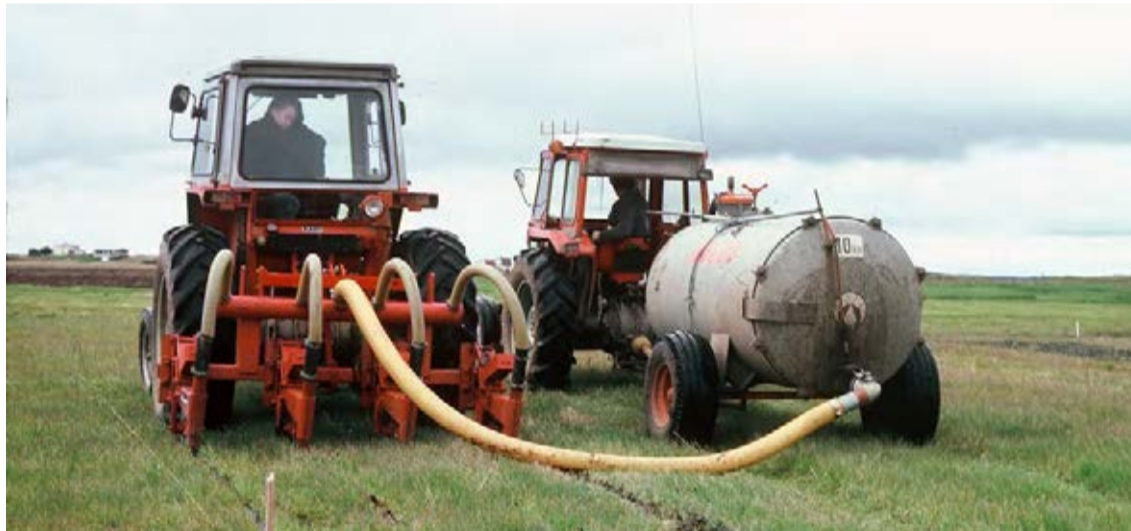
Bútæknimenn á Hvanneyri reyndu niðurfellingu mykju í ýmsum tilraunum en merkilegar tilraunir í þá veru höfðu m.a. verið gerðar í Eyjafirði um og fyrir miðja síðustu öld. Hér er mykja úr Bauer-haugsgugu felld í gróinn túnsvörð með Alfa-Laval mykjufellibúnaði laust fyrir síðustu aldamót. Mynd / Grétar Einarsson
