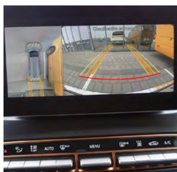
Bakkmyndavélin sýnir bæði ofan á bíl og aftur fyrir sem eykur á öryggi.
