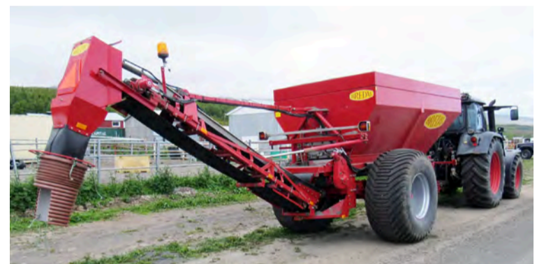
Verktakinn Finnur ehf. fjárfesti í sérstökum vagni til að sanda í skurði og dró þannig úr seinlegri vinnu við að moka sandi með gröfu undir og yfir strengi.
