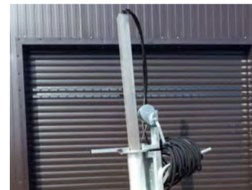
Glussadrifnar gólfhræsur. Vinnudýpt: 1,9 m. Stærð á skrófu: 48 cm. Rotor: 12 kW. Glussaflæði: 75 l/mín. 20 m af glussaslöngum fylgja. Mesta hæð frá gólfi: 2 m. Burðarvirki: Heitgalv./SS stál. Hákonarson ehf. S. 892-4163. Netfang: hak@hak.is
