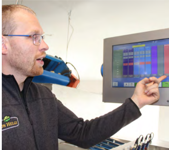
Jón Helgi við stjórnborð flokkunarvélarinnar. Vélin tekur yfir 40 myndir af hverri kartöflu og flokkar í 8 flokka eftir stærð og gæðum.
