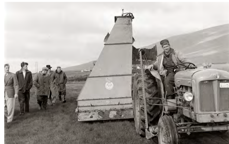
Í sláttutætarinum er þverstæður öxull settur þústum eða spöðum sem tæta eða rífa grasið við sláttinn.
