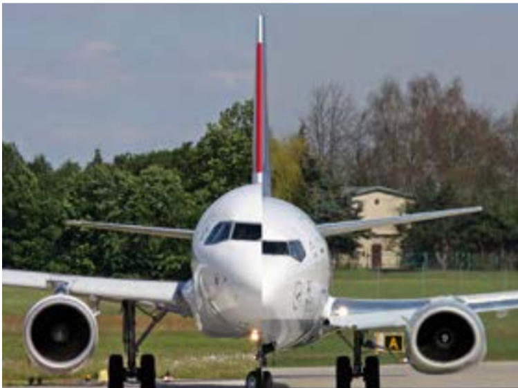
Hér má vel sjá vandann sem Boeing þurfti að glíma við til að koma fyrir stærri hreyflum á MAX 737 vélarnar. Vinstar megin er Airbus 321 og hægra megin MAX 737 þar sem plássíðir fyrir stóran hreyfil undir vængnum reyndist einfaldlega ekki nægjanlegt.
