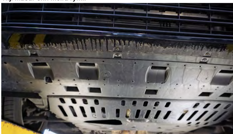
Þykk járnplata er undir vélinni, en ekki plast sem er bara dæmt til að brotna í íslenskri vetrarfærð.
