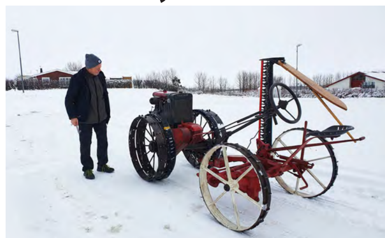
Kristján Helgi við Centaurinn, merkilegu dráttarvélinu sem hann gerði upp af sinni alkunnu sníld. Eitt af því sem er sérstætt við þessa „líðstýrðu vél“ er að bremsur fyrirfinnast ekki á henni og það þarf að snúa henni í gang.
