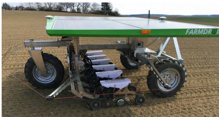
Nákvæmnisbúskapur – sjálfvirkur, sólarrafhlöðuknúinn róbóti sér um að reyta illgresi samkvæmt gps tækni.
