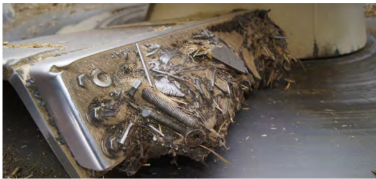
Hér sést að sé settur sterkur segull í fóðurblandara þá gerir hann klárlega gagn!
