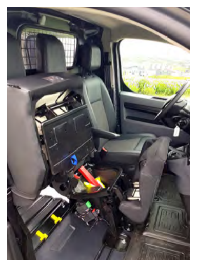
Lúgan frá farmrýminu yfir í ökumannshúsið er undir farþegasætinu. Undir miðjusætinu er lítið hólf.
