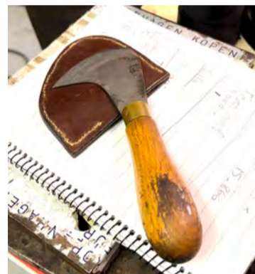
Sill, sem sést hér að ofan, notaður við gerð óla fyrir istað – og kvarthnifur, að neðanverðu eru eftirlætis verkfæri Helgu og mikið notuð.
