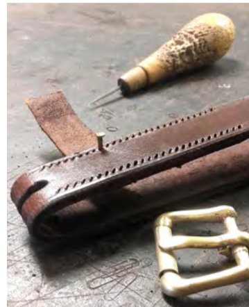
Sill, sem sést hér að ofan, notaður við gerð óla fyrir istað – og kvarthnifur, að neðanverðu eru eftirlætis verkfæri Helgu og mikið notuð.
