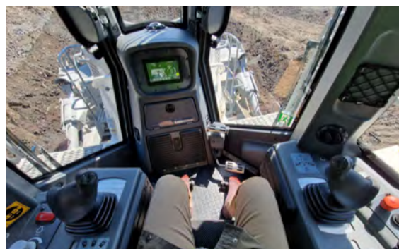
Öikumannssætið snýr aðeins til hægri til að auðveldara sé að líta aftur á riftönnina. Tveir stjórnþinnar stýra flestum hreyfingum.
