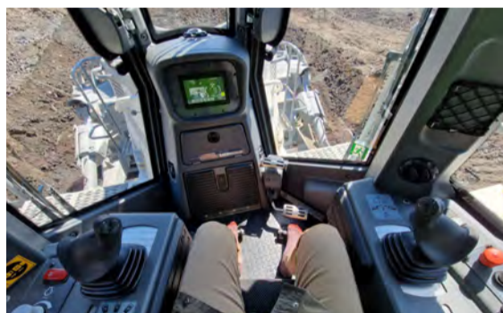
Ökumannssætið snýr aðeins til hægri til að auðveldara sé að líta aftur á riftönnina. Tveir stjórnþinnar stýra flestum hreyfingum.
