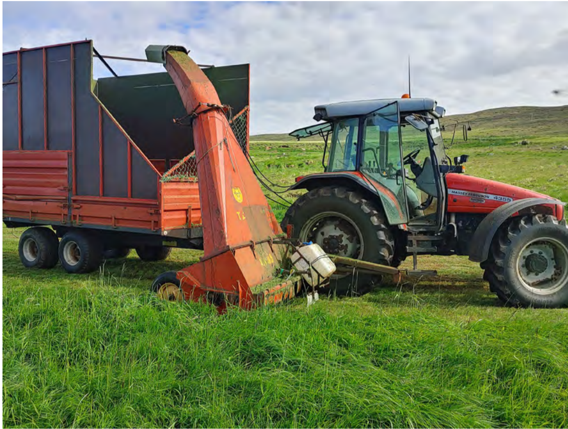
Sláttutætari á Þóroddsstöðum við heyskap í sumar. Þegar vandað er til verka er hægt að gera gott og ódyrt fóður með þessari heyverkunaraðferð. Afköstin eru þó minni en þegar pakkað er í rúllur. Mynd / Gunnar Þórarinnsson
