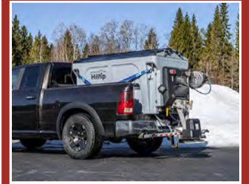
Hilltip Icestriker 900–1600L Salt og sanddreifari í tveim stærðum fyrir stóra pallbíla og minni vörubíla. Rafdrifinn 12V.
