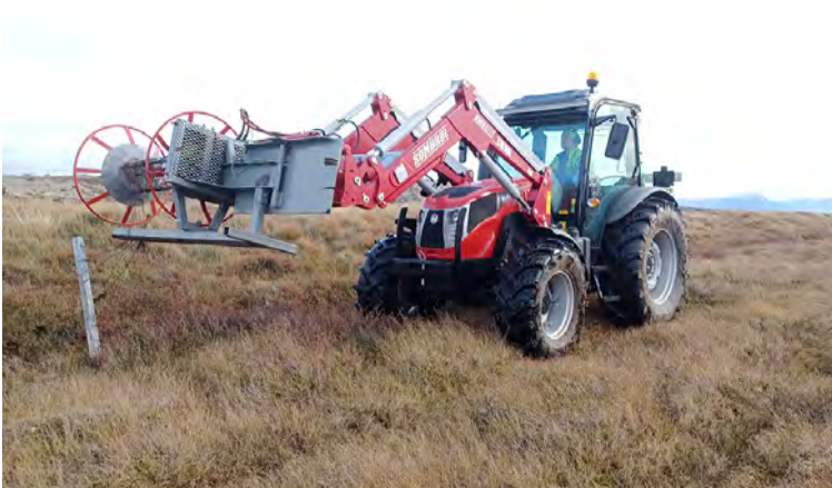
Girðingavinda sem fjarlægir gamlar girðingar með auðveldu móti. Heimasmíðuð uppfinning Hjartar Friðrikssonar í Skóghlíð. Mynd / Aðsend
