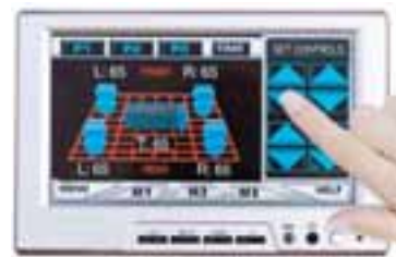
LCD-snertiskjár með stýringum og aflestri fyrir loftpúða.
