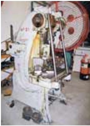
Hjámiðjupressa til sölu. 40 t slag. Slaglengd 75 mm. S. 564 1981 & 846 4696.
