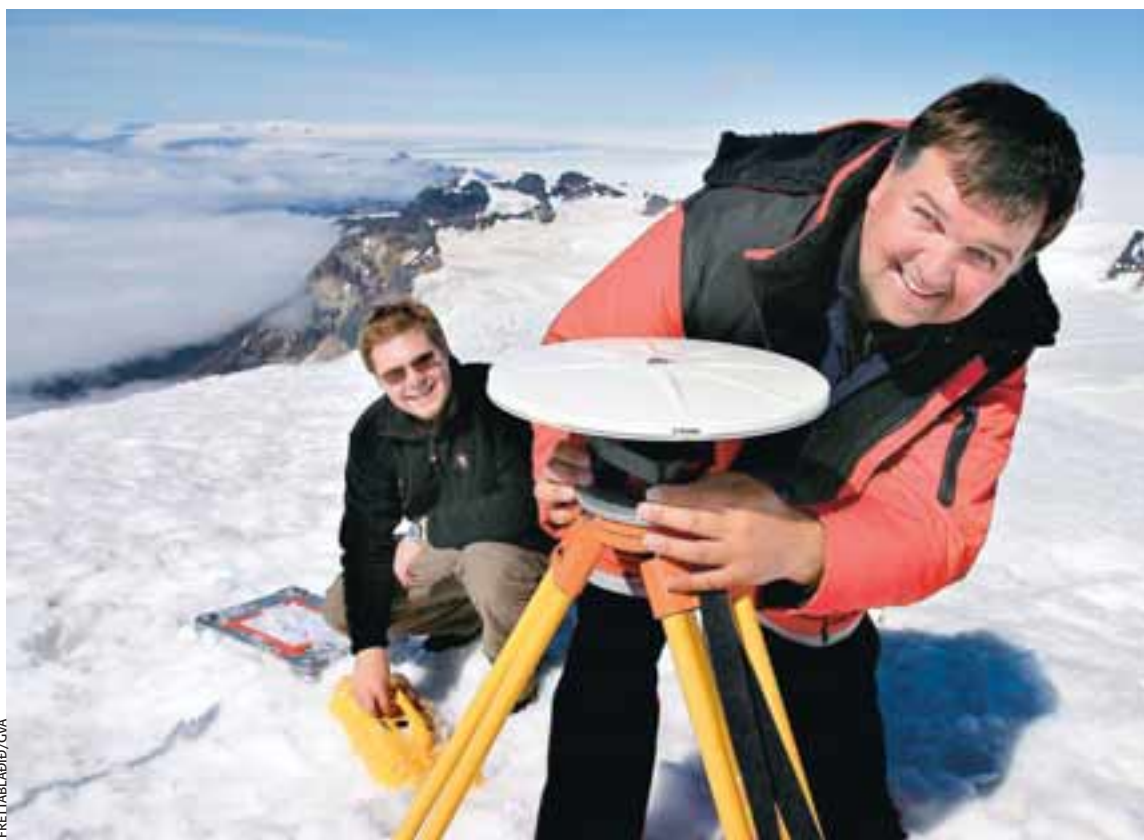
HVANNADALSHNÚKUR MÆLDUR Þórarinn Sigurðsson landmælingamaður (t.h.) og Guðmundur Valsson koma mælitækjunum fyrir á Hvannadalshnúki. Mælitækin safna á næstu sólarhringum gögnum með hjálp gervitungla áður en hægt verður að staðfesta hæð hnúksins.
