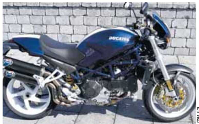
„Stóri bróðir“ S4R. Útlitstruflandi vatnskassinn og tilheyrandi slönguskógur gefa sleggjuaflið til kynna.
