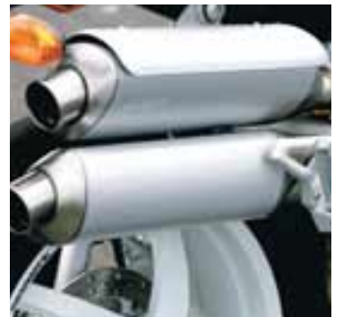
Annað einkenni er 2-f-1-1-2-pústið. Kútarnir liggja hátt og þétt upp að hjólinu.
