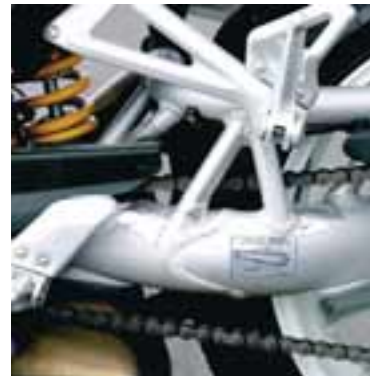
Sams konar ál-einarmur heldur afturhjólínu bæði á S2R og S4R.
