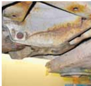
Hér sést undirvagn á þriggja ára bíl sem var ekki ryðvarinn áður en hann fór á götuna.
