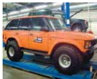
Íslenska útgáfan af G4 Challenge er með uppgerða 5 strokka 160 ha díselvél úr Discovery, girkassa úr Defender '99, millikassa úr Discovery '97 og drif úr Land Rover '75.
