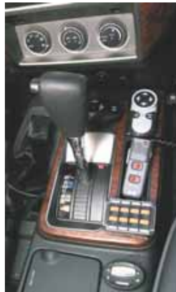
Allur frágangur er mjög snyrtilegur. Rofar fyrir leitarljós, aukaljós, drífæsingar, olúfyring og fleira taka lítið pláss.
