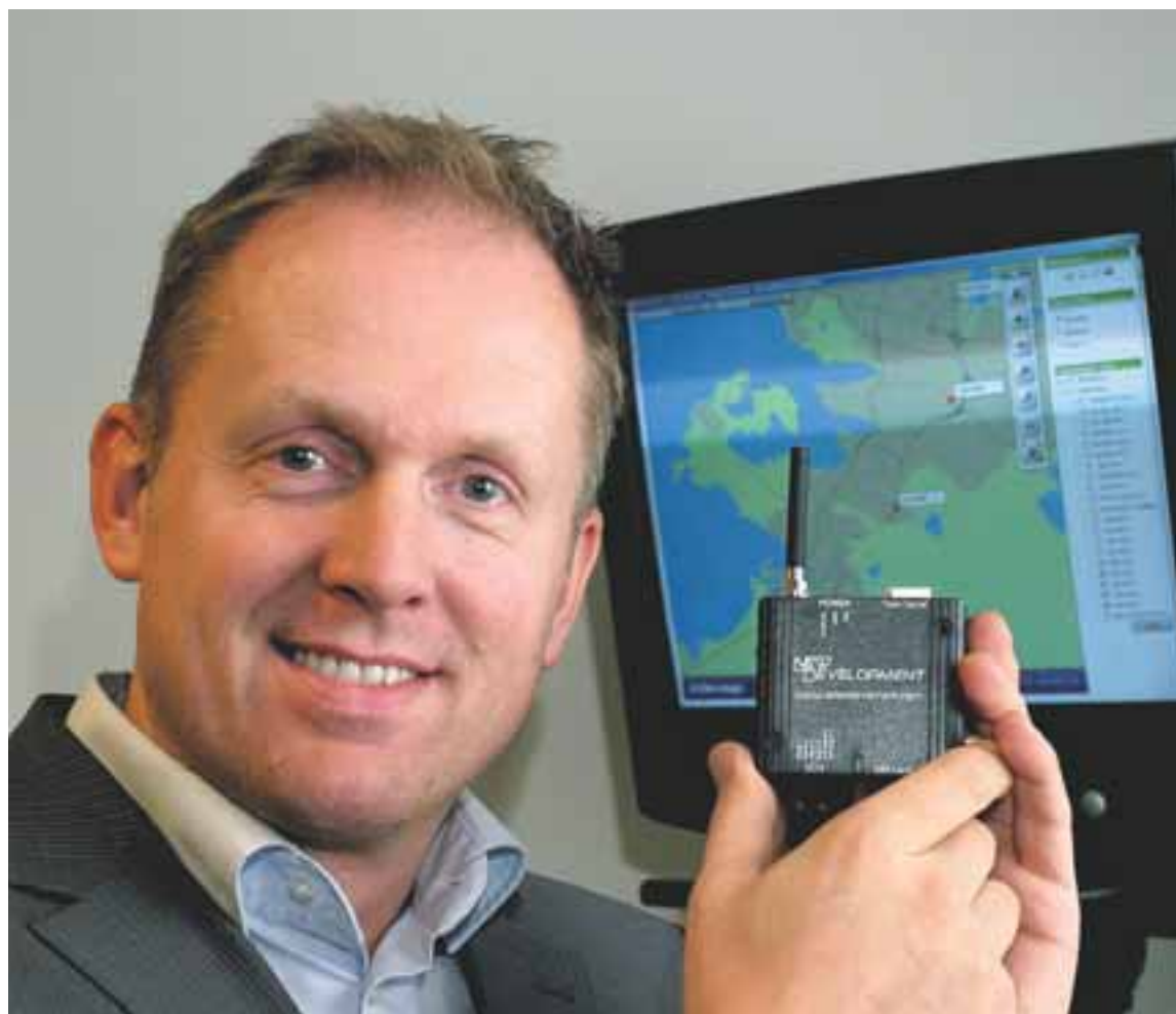
Fríðgeir með akstursrita sem er hluti af Saga-kerfinu. Með honum má fylgjast með bílnum og aksturshegðun bílstjórans.
