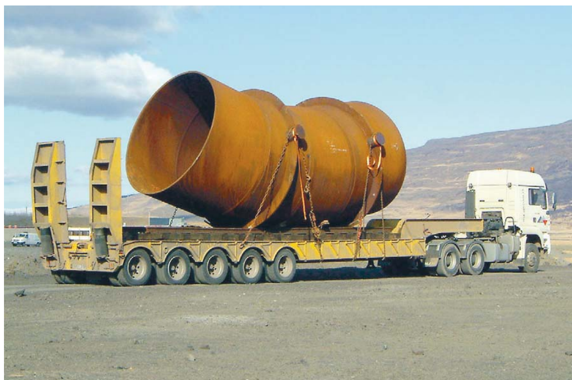
TRÖLLVAXIN STÁLÖR Starfsmenn Slippstöðvarinnar unnu að samsetningu á röraeingum í aðfallsgöngum Kárahnjúkavirkjunar áður en félagið varð gjaldþrota. Hver eining vegur um 45 tonn.
