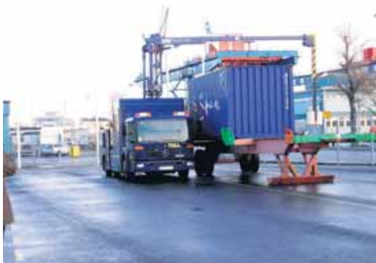
GEGNUMLÝSINGARBÍLL Þessi gegnumlýsingarbíll skoðar gáma á þremur mínútum en eins og aðstaða tollayfirvalda er í dag verður að handlanga innhald gáma í gegnum eftirlitstæki.
