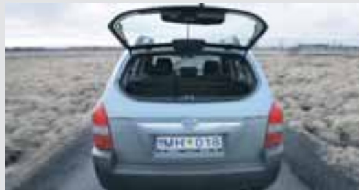
Farangursrýmið opnast í tvennu lagi, annað hvort allur hlerinn eða bara rúðan.
