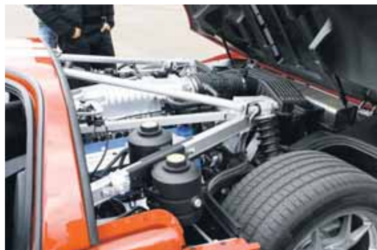
Hestúsið er fyrir aftan húsið og hýsir 550 uppgefna hesta. Stífurnar sem tengjast afturfjöðruninni eru áberandi.
