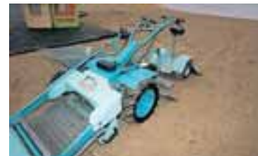
DRÁTTARVÉLIN GÓÐA Þessi dráttarvél er notuð til að sigta út steina og skeljar úr sandinum.
