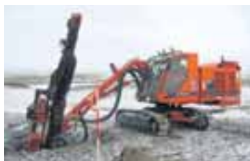
Sprengibor sem er eingöngu notaður til að bora fyrir sprengiefni.
