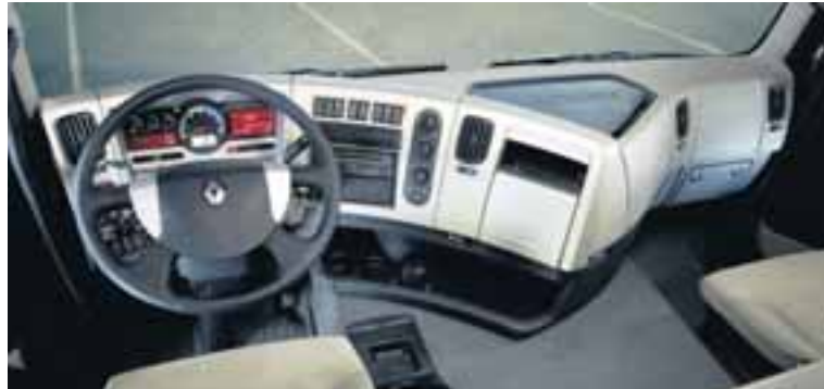
Nýja kynslóðin færir öikumönnum nýja hönnun á mælaborði, sem er nú byggt í sveig um öikumanninn með það fyrir augum að bæta vinnuástöðu.
