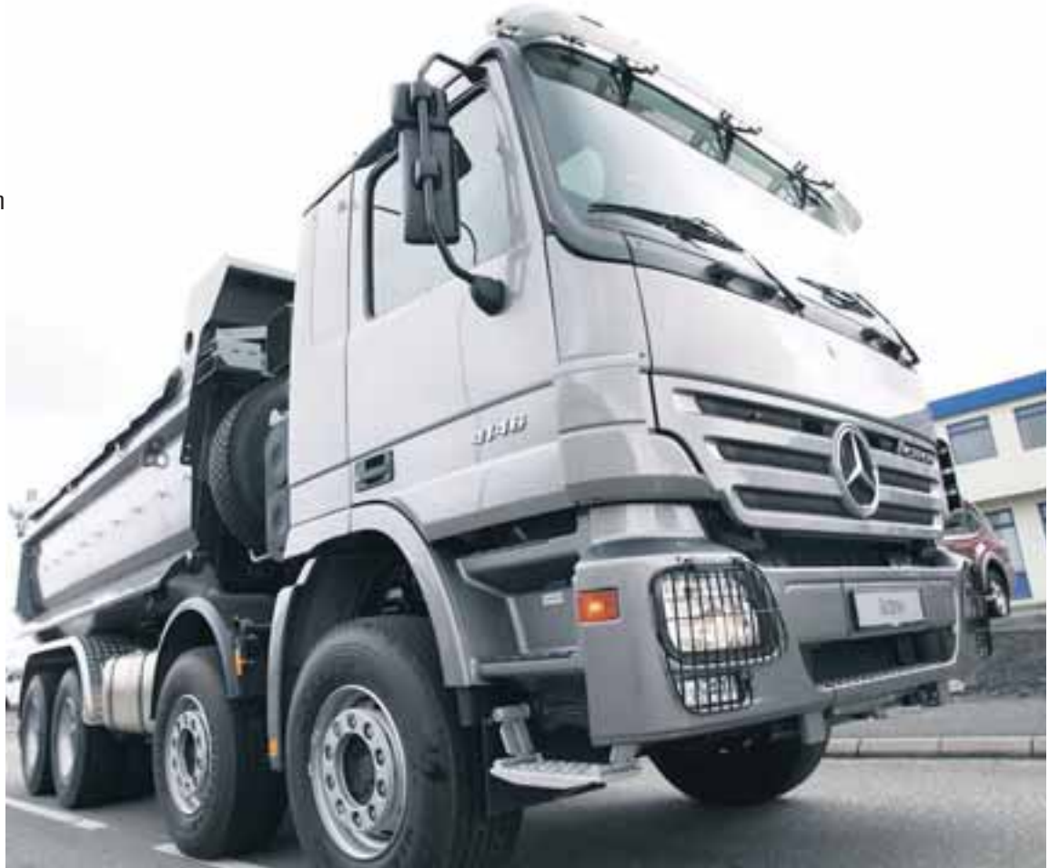
Bíll sá er Fréttablaðið hafði til skoðunar var Actros 4146. Pallur og hús eru samlit og pallurinn smíðaður úr sérstyrktum efnum og er botn pallsins 8 mm þykkur. Bláðamaður Fréttablaðsins hafði á tilfinningunni að engin þörf væri á meiraprófi enda með eindæmum auðvelt að aka bílnum.
