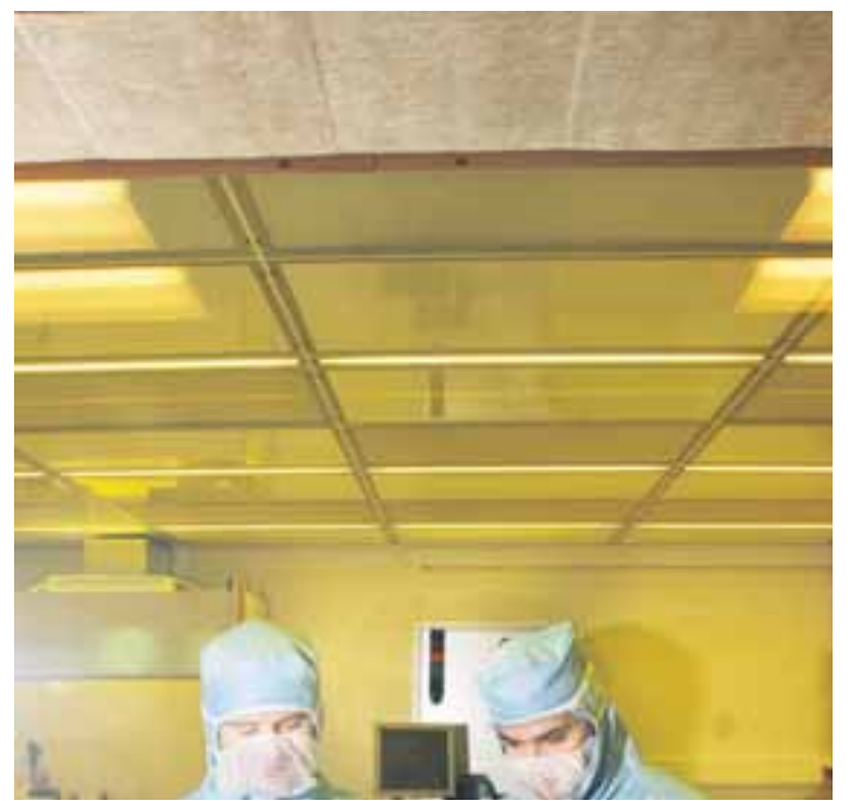
VÍSINDAMENN VIÐ STÖRF Unnið er með smæstu stærðirnar í rykfriú hreinherbergi. Full loftskipti eru á þrjátíu sekúndna fresti og er lýsingin gul svo betur megi vernda ljósnæm efni sem þar eru notuð.
