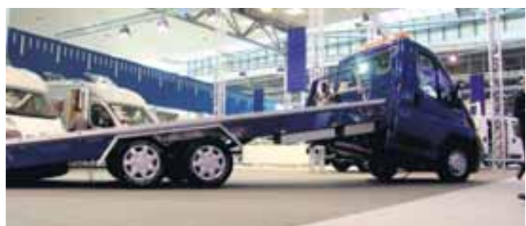
Brotinn í tvennt! Viljandi auðvitað, sniðug glussatjakkdrifin lausn fyrir bílaflutninga með Peugeot Boxer drifhaus við sérsmíðaða grind og afturfjóðrun.
