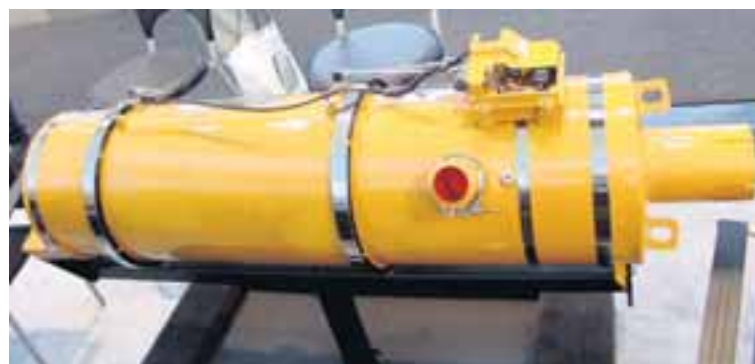
Ekkert smáflykki, afmengunarbúnaðurinn í vörubílum framtíðar. Hér er Caterpillar-kúturinn.
