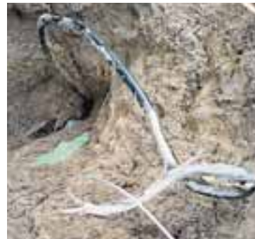
SLITINN LJÓSLEIÐARI Þótt þeir séu mikilvægir fyrir boðflutninga milli landa láta ljósléiðarar ekki mikið yfir sér. Þessi var slitinn í Skotlandi fyrir rúmu ári síðan.
