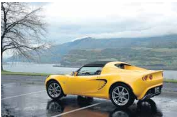
Lotus Elise er gríðarlega léttur, en sumar týpur vege einungis um 700 kíló. Þessum léttleika er náð með notkun á áli og koltrefjum í grind og yfirbyggingu.
