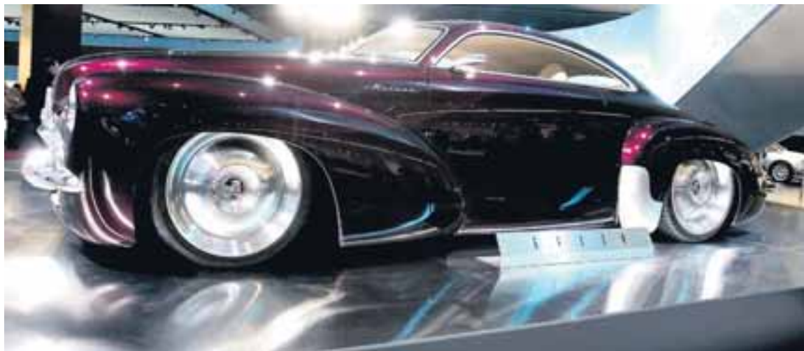
Holden Efíjy hugmyndabíllinn er án efa einn allra fallegasti gripurinn á sýningunni. Hann er byggður á klassískri hönnun FJ Holden frá 1953 og átti upphaflega að frumsýna hann árið 2003 í tilefni af 50 ára afmæli Holden. Bíllinn er rúmir 5 metrar á lengd og skilar V8-vélin tæplega 660 hestöflum, ellefu sinnum fleiri en FJ. Efíjy mun aldrei rata í almenna framleiðslu.
