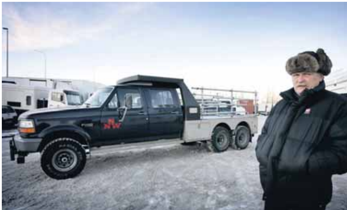
Jón Garðarsson við Shotmakerinn sem hann smíðaði sérstaklega fyrir íslenska kvikmyndagerð. Billinn er sex hjóla með drifi á öllum, búinn þremur öxum.
