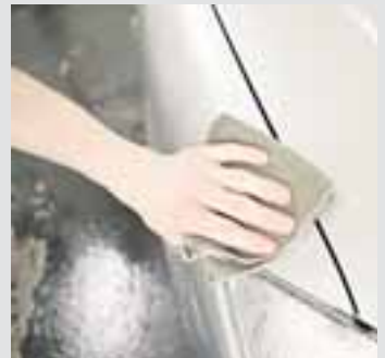
6. Eftir að bryngljái hefur verið borinn á bifreiðina er hann látinn þorna næstu fjóra til sex klukkutímuna. Að þeim tíma liðnum er afgangsefnið þurrkað af.
