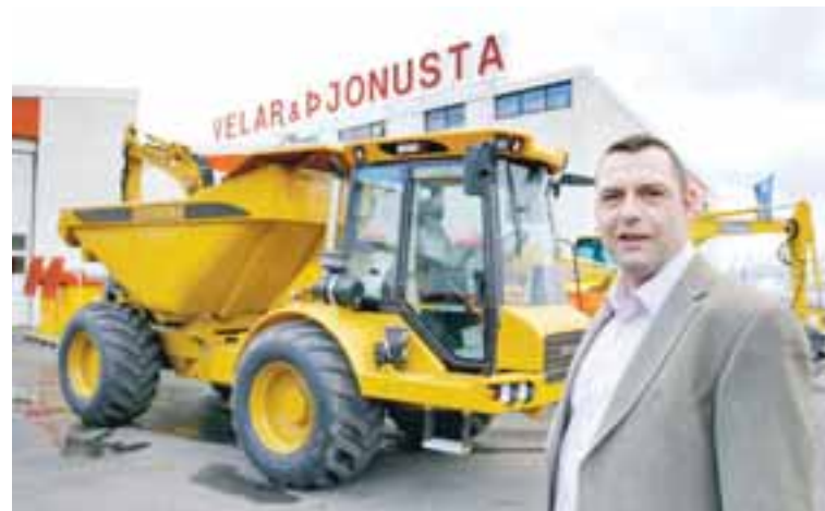
Hyderma-búkollan frá Vélum og þjónustu vegur sjö tonn en má bera tíu til ellefu tonn.
