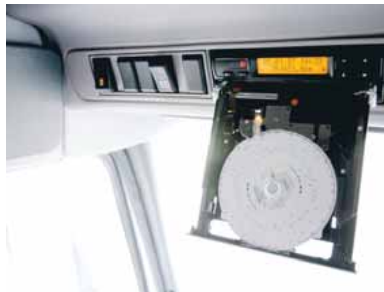
Kjaftakerlingin er skífa sem sýnir Vegagerðinni hvernig bílstjórinn hagar akstrinum.
