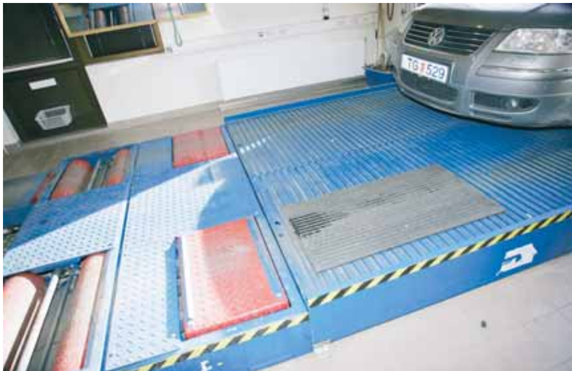
Bíll keyrður inn á forgreiningarþekkin sem metur hjól, hemla, dekk og dempara. Heildarskoðun tekur um tíu til fimmtán mínútur.
