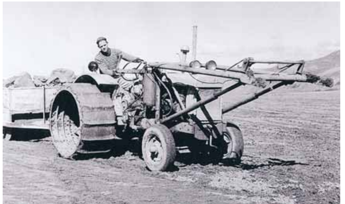
Þessa mynd tók Ásgeir Long í Krýsvík sumarið 1955 af Oliver 80 Standard dráttarvél, árgerð 1947. Hún var þá sú stærsta og öflugasta, tvö og hálf tonn að þyngd og 38 hestöfl. Á vélinni eru ein af fyrstu moksturtaekjunum sem til landsins komu árið 1947.
