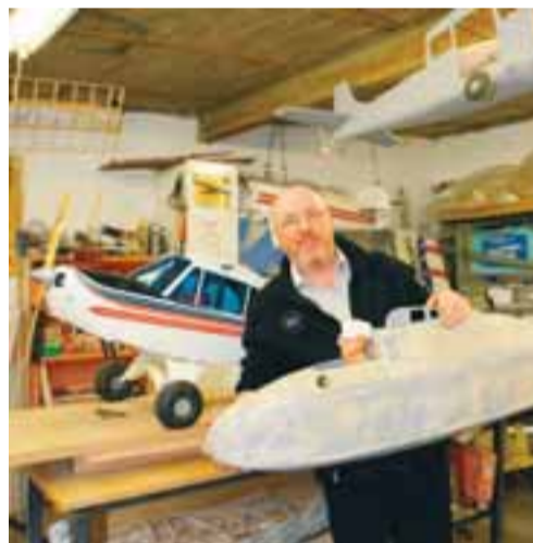
Guðjón með Piper Super Cub í mælikvarðanum 1/3,85 sem er samlega nákvæmt líkan af flugvél sem var notuð í James Bond-kvikmyndinni The Living Daylights. Módelið er með vænghaf upp á 2,8 metra og er knúð áfram af bensínmotor sem er með 45 rúmsentimetra sprengrými. Það tók um það bil 5 mánuði að smíða vélina.
