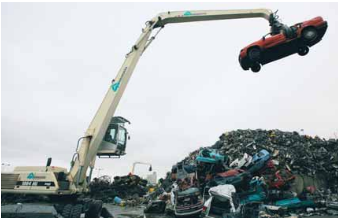
HRINGRÁS Bílar sem koma inn til Hringrásar í endurvinnslu eru olíu- og vökvatæmdir, rafgeymar eru fjarlægðir og dekk tekin undan. Bílarnir eru fjögur hundruð talsins í hverjum mánuði þegar mest lætur.
